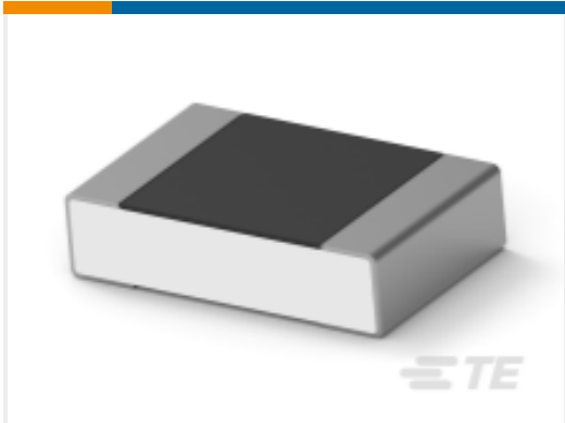
TE Part # 9-2176376-6 RQ 0805 121K 0.1% 10PPM 1K RL
