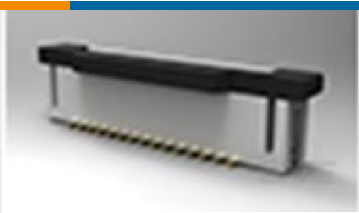
TE Part # 2-1734248-0 1.0 FPC, ZIF V/T, SMT, 20P
