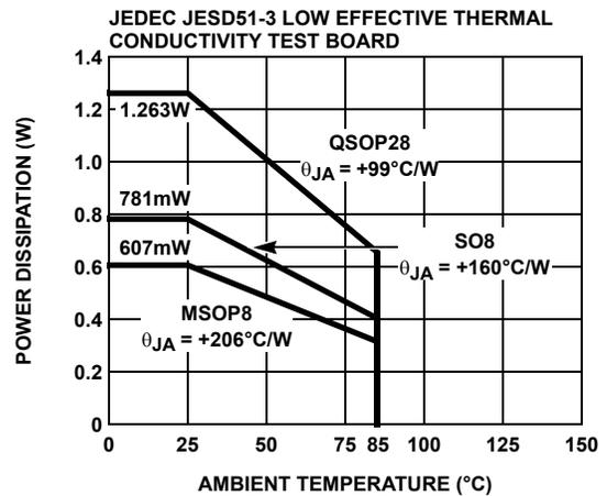
FIGURE 30. PACKAGE POWER DISSIPATION vs AMBIENT TEMPERATURE
