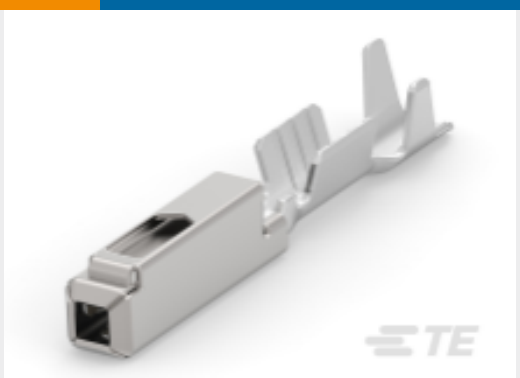
TE Part # 5-968220-5 MQS0,63 Au rec CB unseal. 0,2-0,35
