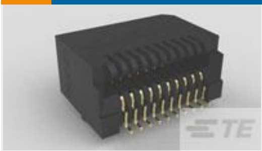
TE Part # 1658197-1 SFP, 20 POSN, 0.8MM PITCH, SUR
