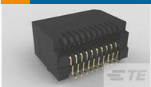
TE Part # 1658197-1 SFP, 20 POSN, 0.8MM PITCH, SUR
