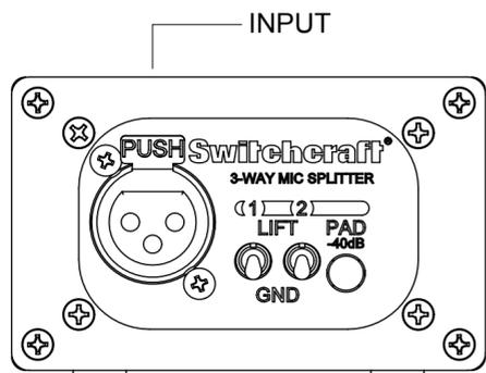
LIFT/GND TOGGLE SWITCH      -40dB PAD PUSHBUTTON SWITCH
