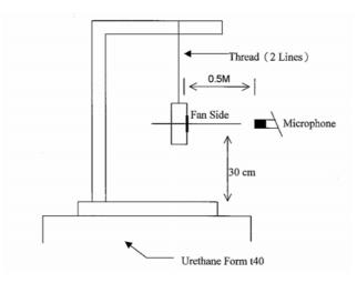
0.5 METER FROM MICROPHONE TO FAN INTAKE
