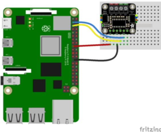
Pi 3V to ADC VIN (red wire)
