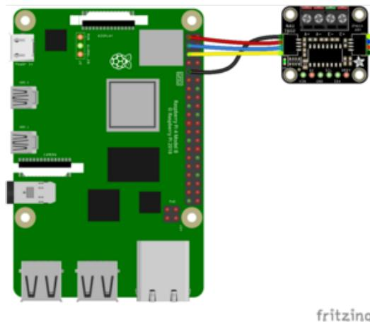
Pi 3V to ADC VIN (red wire)
