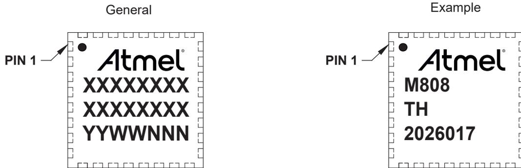
Figure 35-5. 48-Pin TQFP (7x7x1 mm)
