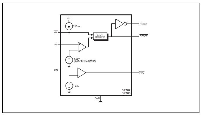
Fig. 2: SP707-SP708 Block Diagram
