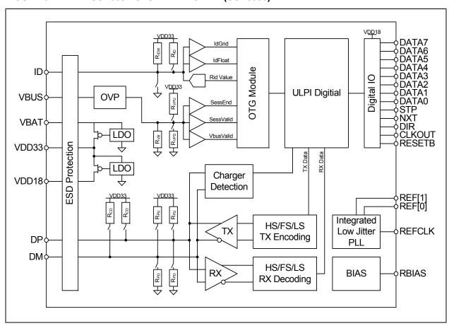
FIGURE 5-2: USB333X SYSTEM DIAGRAM (USB3330)
