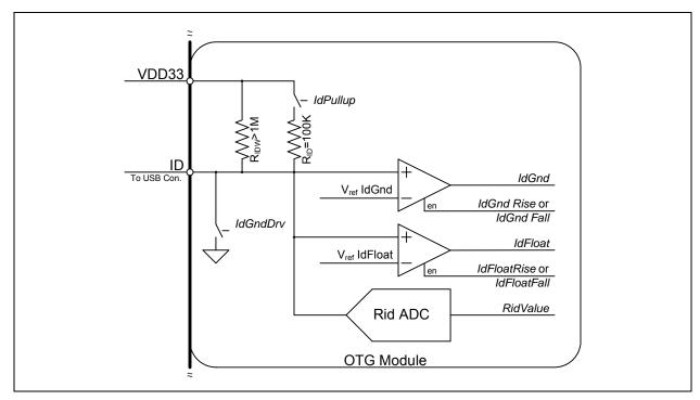
FIGURE 5-9: USB333X ID RESISTOR DETECTION CIRCUITRY
