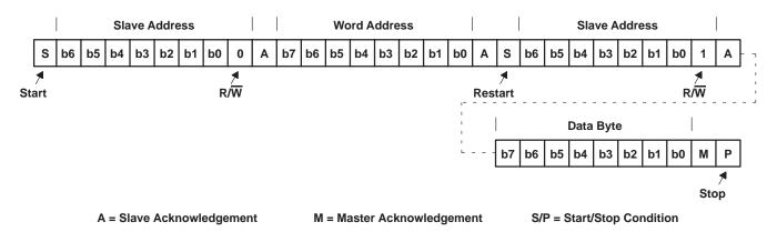
Figure 3-9. Serial-Bus Protocol—Byte Read
