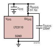
Figure 16. SV<sub>SYS</sub> Filtering
