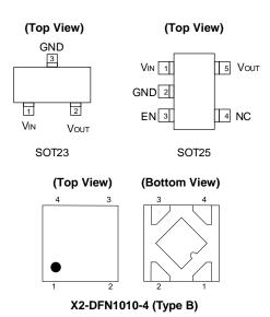
Pin 1 – V<sub>OUT</sub>, Pin 2 – GND, Pin 3 – EN, Pin 4 – V<sub>IN</sub>
