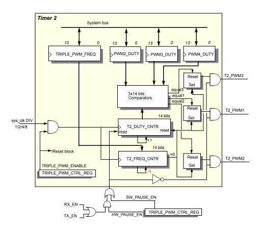
Figure 48: Timer 2 PWM Block Diagram
