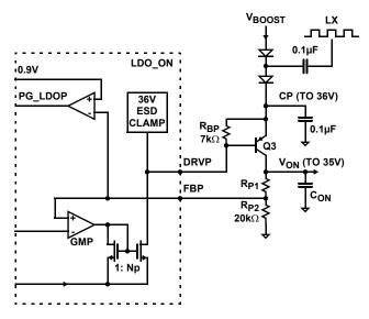
FIGURE 27. V<sub>ON</sub> FUNCTIONAL BLOCK DIAGRAM
