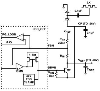
FIGURE 28. VOFF FUNCTIONAL BLOCK DIAGRAM
