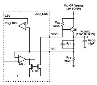
FIGURE 29. VLOGIC FUNCTIONAL BLOCK DIAGRAM
