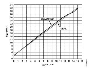
Figure 30. Iout vs. Iout Code
