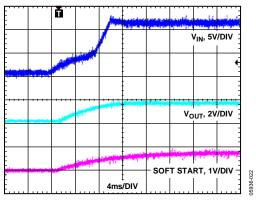
Figure 22. Power-On Response, EN Tied to  $V_{\text{IN}}$
