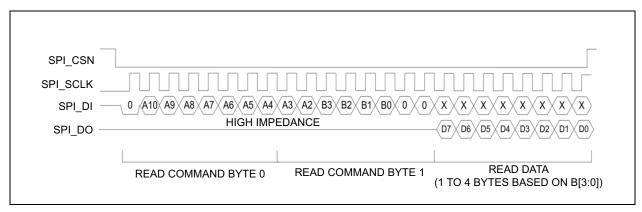
FIGURE 3-19: SPI REGISTER READ OPERATION – HIGH-SPEED MODE
