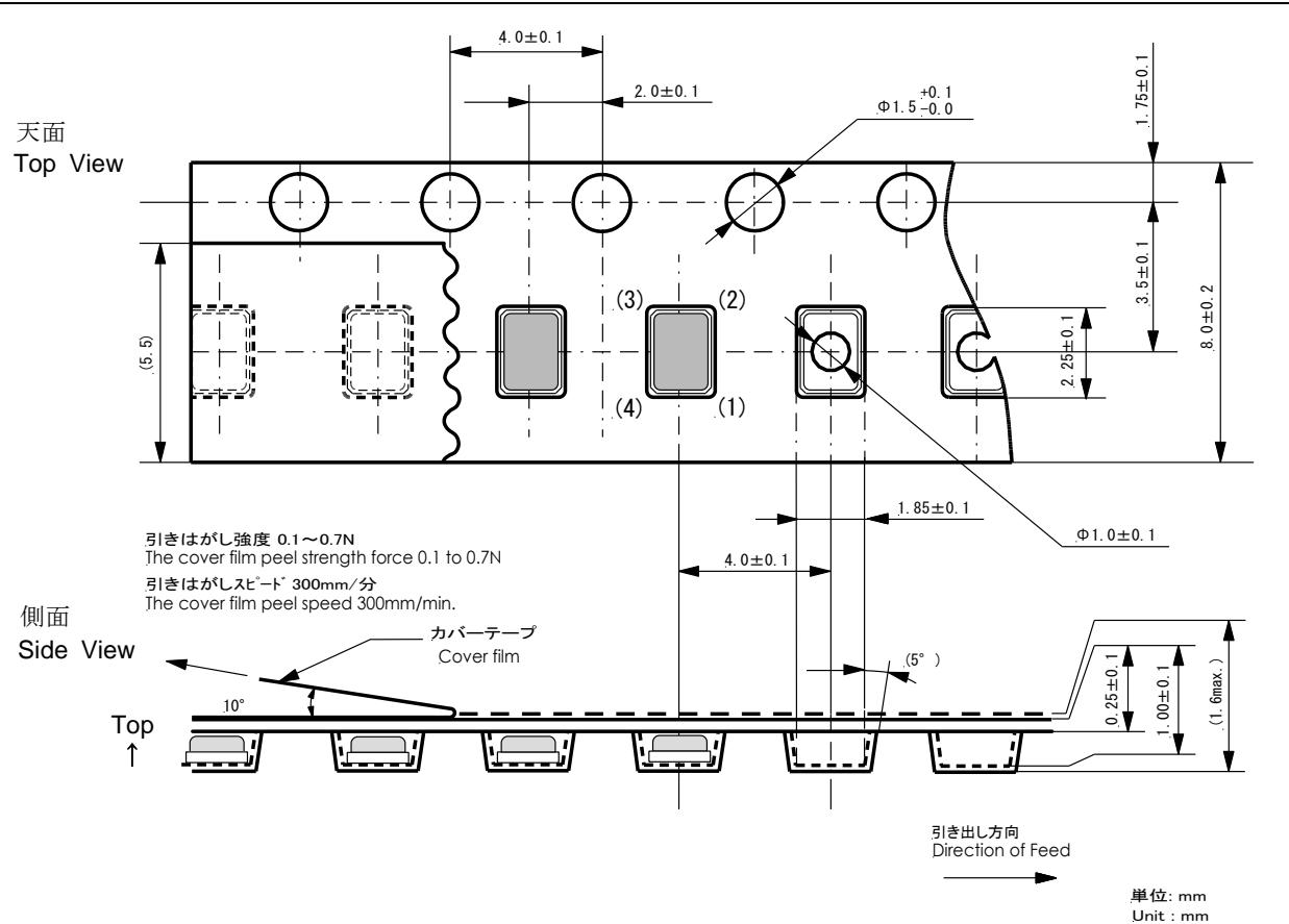
第2図 プラスチックテープの外形寸法図
