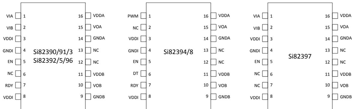
Figure 6.1. Si8239x SOIC-16<sup>1</sup>
