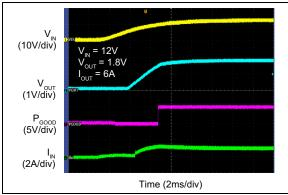
FIGURE 2-20: V<sub>IN</sub> Soft Turn-On.
